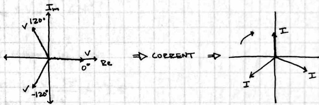
$$V_{BC} = V_p \cos(\omega t - 120^\circ) - V_p \cos(\omega t + 120^\circ)$$
